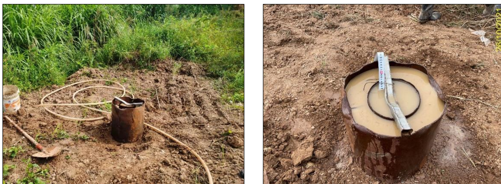
图 5-6-12 R2、R3 双环入渗试验
