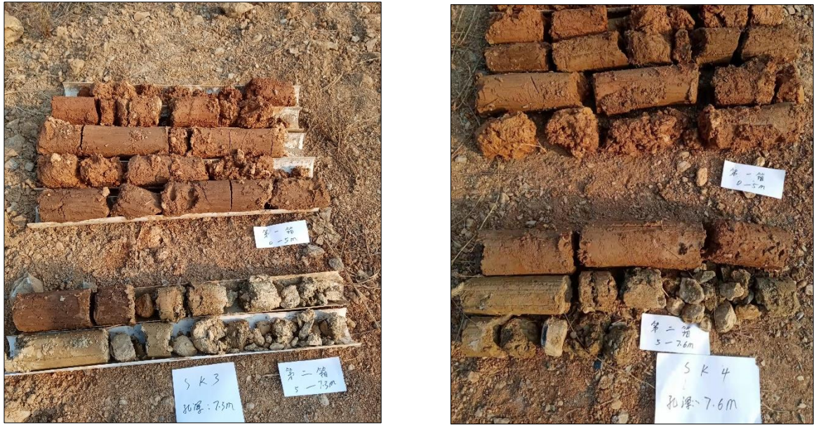
图 5-6-7 岩芯照片（钻孔 SK3、SK4）
