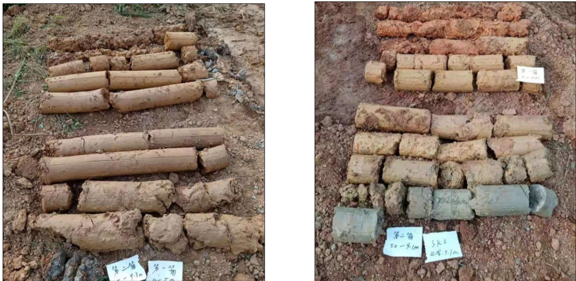
图 5-6-6 岩芯照片（钻孔 SK1、SK2）
