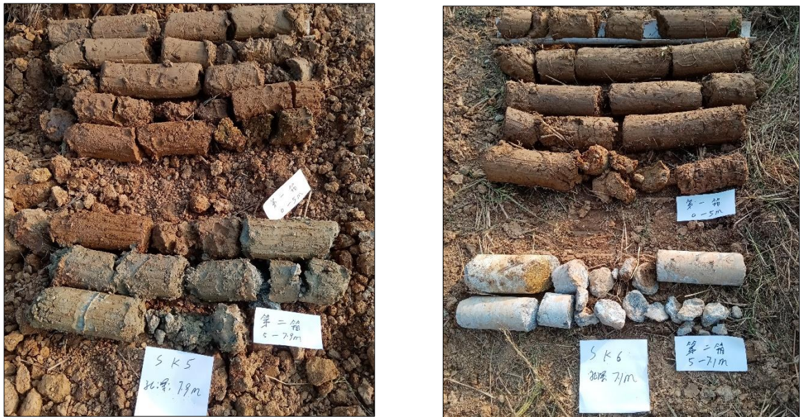
图 5-6-8 岩芯照片（钻孔 SK5、SK6）
